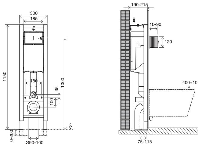
Спецификация продукта : Система инсталляции на 3/6 л, 300 мм . E33130RU. Коллекция : Общая категория. ВЕС : 16 кг. МАТЕРИАЛ : N/A. ТИП УСТАНОВКИ : Крепление к стене. CONSOMMATION D'EAU : Стандарт: 3/6 л.
